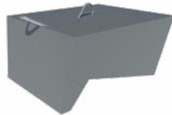
BETONG-PLOGANKARE Betongankare till förankring av flytbryggor. Bygel: Rostfri Ø 18 eller stål Ø 30 mm Vikt: 1 200/1 800 kg
