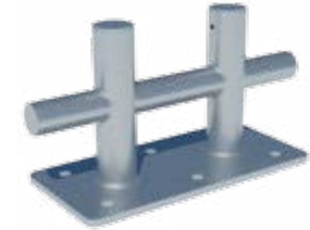
H-POLLARE – Galvaniserat stål Gedigen skeppspollare för större fartyg. Rör: Ø 60 × B 520 × H 208 mm Bottenplatta: L 520 × B 250 × H 15 mm
